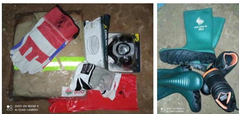
EPI : gants et protection pour les herbicideurs (à gauche), bottes et chaussures de sécurité (à droite)
